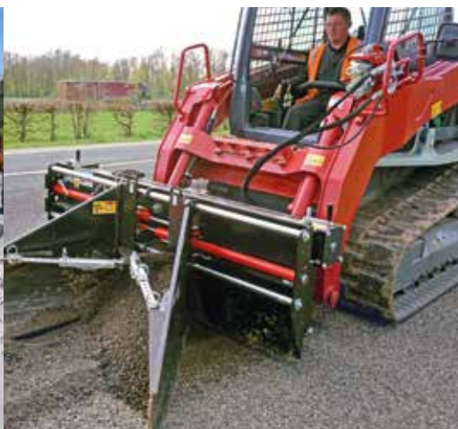
ST 200. Die zusätzliche Klappe ermöglicht die Durchführung von Arbeiten im Straßenbankett.
